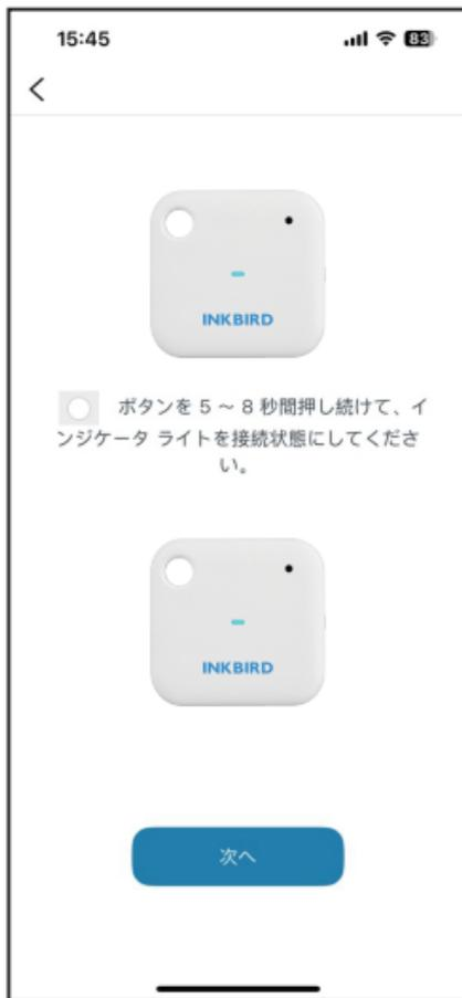
3.3.4 表示ランプが点滅するまで操作ボタンを押し続けて、ペアリング状態入ります。「確認」をクリックして続行します。
