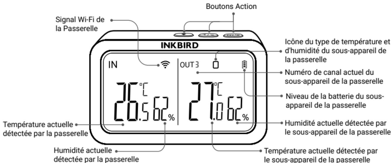
La passerelle Wi-Fi INKBIRD est spécialement conçue pour certains appareils Bluetooth/sans fil INKBIRD, elle offre une connectivité au réseau mobile et permet de gérer tous les appareils synchronisés à l'aide de l'application INKBIRD.
