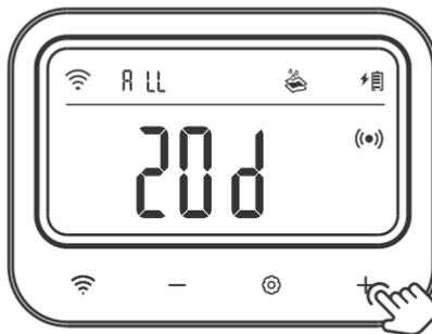
Paso 3: Después de activar la función antical, ajuste el número de días consecutivos sin que se abra la válvula de control. El parámetro correspondiente parpadeará. Pulse la tecla + o – para ajustar el parámetro.
