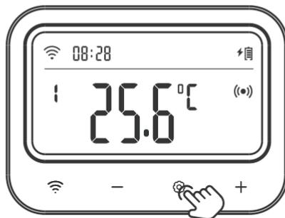
Paso 2: Mantenga pulsada la tecla 1 durante 2 segundos o no la pulse durante 60 segundos para guardar los ajustes y volver al modo de trabajo.
