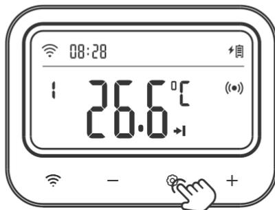
Paso3: Pulse brevemente la tecla
