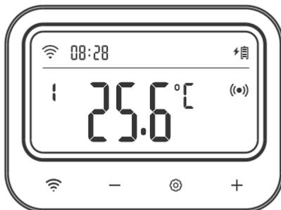
Paso 2: Mantenga pulsada la tecla ((•)) durante 2 segundos o no la pulse durante 60 segundos para guardar los ajustes y volver al modo de trabajo.
