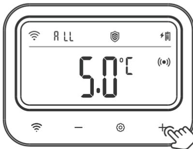
Paso3: Después de activar la función antihielo, ajuste el número de días consecutivos sin acción de apertura de la válvula de control. El parámetro correspondiente parpadeará. Pulse la tecla + o – para ajustar el parámetro.
