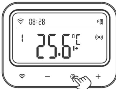
Paso 2: Pulse brevemente la tecla
