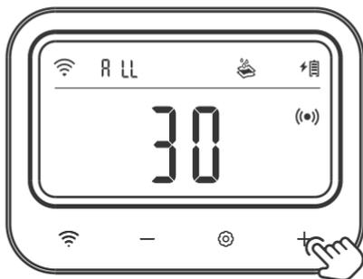
Paso 4: Pulse la tecla
