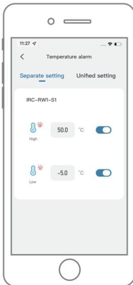
Interfaz de ajuste de alarma de alta/baja temperatura
