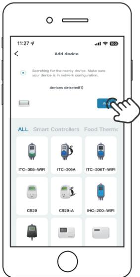
**Paso 3:** Abra la aplicación INKBIRD y haga clic en "Añadir" en la esquina derecha. Añade el IRC-RW1 después de buscar automáticamente el dispositivo.
