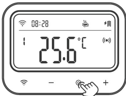
Paso5: Mantenga pulsada la tecla
