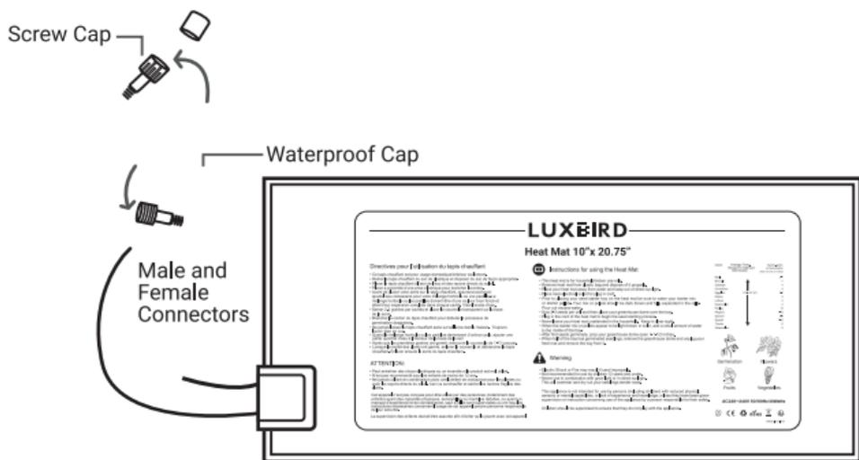
Schritt 1: Stecken Sie den Stecker der externen Heizmatte in die Buchse der Hauptheizmatte (mit dem Controller).
