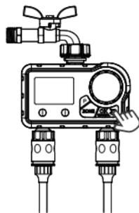
Halten Sie die "OK"-Taste gedrückt, um das Ventil manuell einzuschalten. Nachdem Sie ein "click" gehört haben oder nach 5 Sekunden, drehen Sie den Regler auf "OFF", um das Ventil zu schließen. Wiederholen Sie den obigen Vorgang 3~5 Mal. Die Zeitschaltuhr verfügt über 2 Zonenausgänge, wiederholen Sie die obigen Schritte für jeden Ausgang separat (drücken Sie die Taste "ZONE", um die Zonen zu wechseln).
